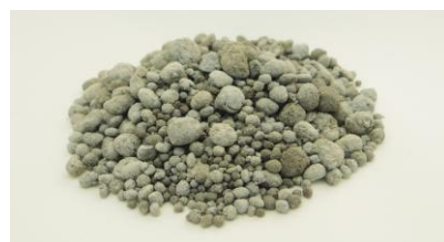
独自開発の「造粒固化」技術を用いた 土木資材「造粒石」を作っています。
