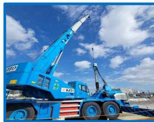
80 t ラフタークレーン 大型クレーンで作業します
