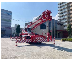
100tラフタークレーン
